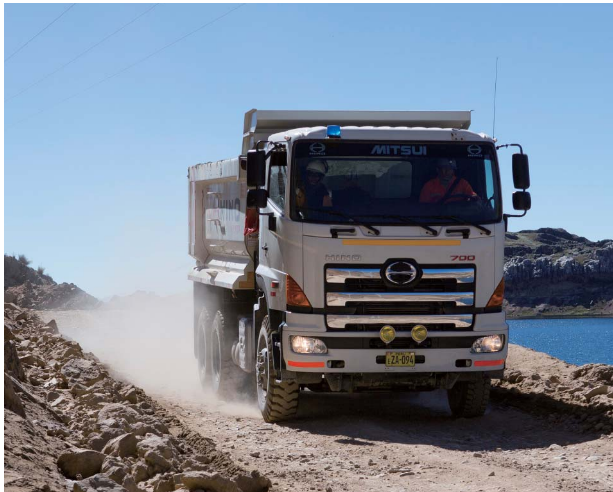
在氧氣濃度很低的高原地區，卡車從專為高原地區使用所設計的裝備得到額外的動力。
