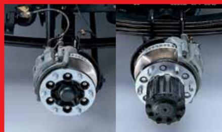
**前後通風碟式煞車系統**
